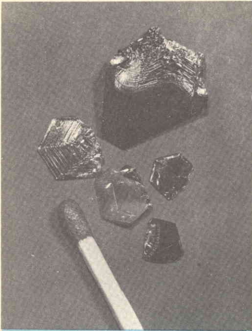
Fig. 2 - Tipica serie di cristalli di carburo di silicio cresciuti nella fornace a sublimazione.
